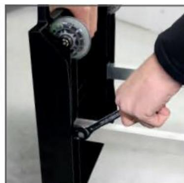
Collegare tra loro gli 8 moduli ad arco fino a che non scattano in posizione facendo "clic". Alla fine i moduli vanno collegati tra loro anche mediante viti (M6 x 16 mm) e i relativi dadi di bloccaggio (M6). Per farlo sarà necessario disporre di una chiave a brugola da 4 e una chiave da dadi da 10.
